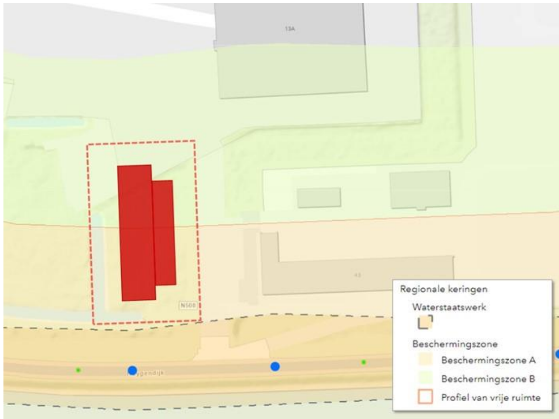
afbeelding 8: ligging nieuwe 50kV gebouw in de beschermingszone A (oranje) en B (groen) van de regionale waterkering (bron: Legger HHNK)
