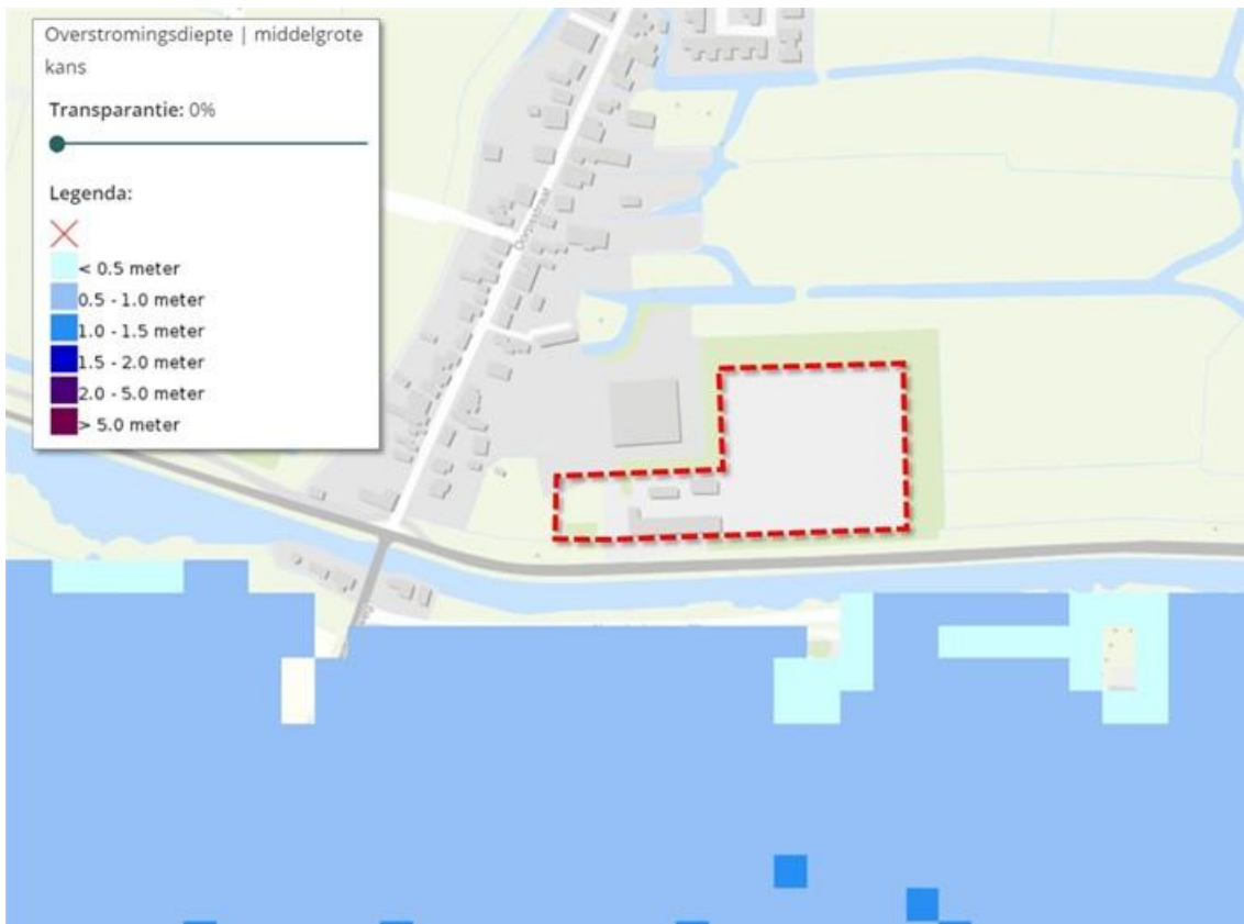
afbeelding 9: overstromingsdiepte, middelgrote kans (transformatorstation is met een rode stippellijn aangeduid) (bron: Klimateffectatlas)
